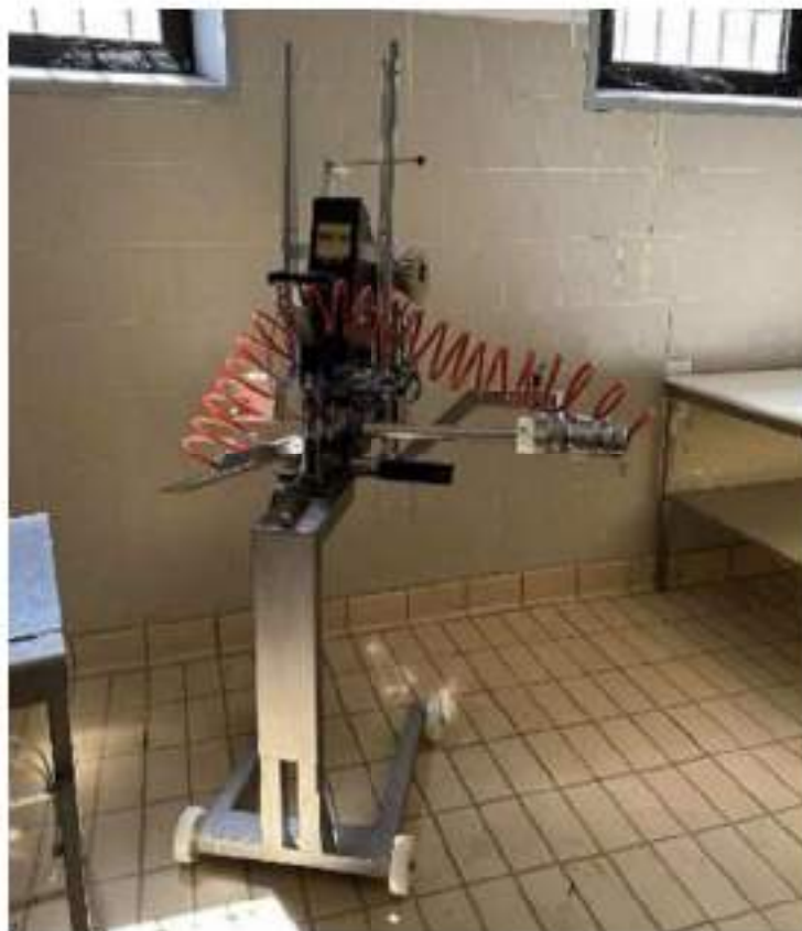
Piano terra. Locale 17: Lavorazione insaccati, cotto e wustel. Clippatrice. Mod Poly-Clip. Anno di messa in servizio: 2004 – cod.01-035.
