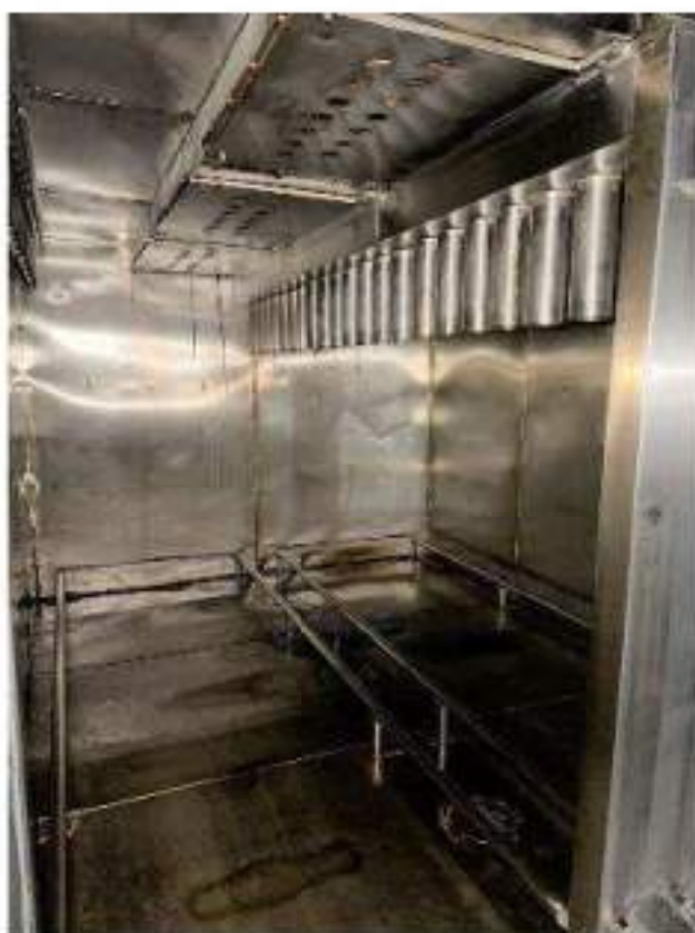
Piano secondo – Locale 10. Forno c/generatore di fumo. Mod. Fessman/Tak Tribus 705. 8 Kw. Anno di messa in servizio: 2007 – cod.02B-001
