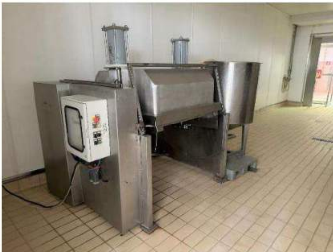
Piano terra. Locale 15-16. Miscelazione salina cotti, Zangola per vasche. Mod. O.M.P. Possenti. 15 Kw Anno di messa in servizio: 1986 – cod.01-022.
