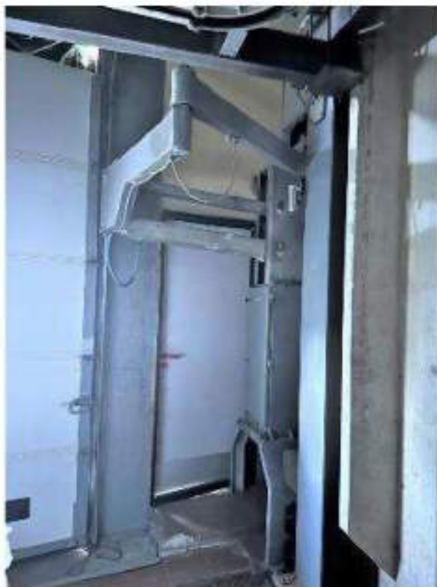
Piano terra. Locale 18A: Scarico came fresca. Braccio meccanico per scarico. Mod. Martinalli. 1,6 Kw. Anno di messa in servizio: 1998
