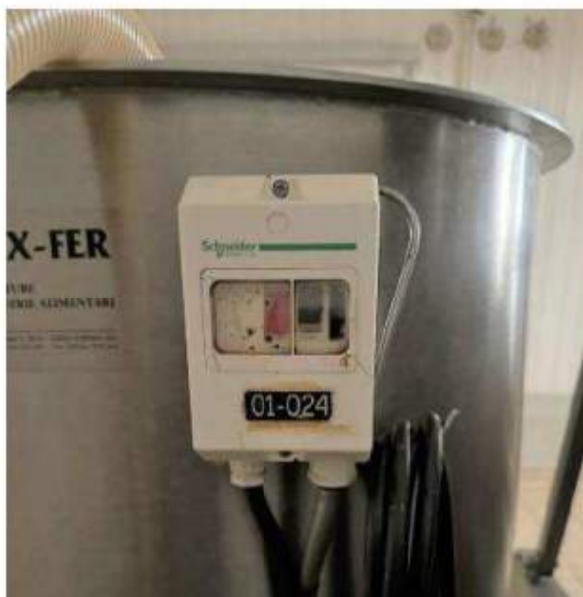
Piano terra, Locale 15-16. Miscelasalina. Mod. Inox-Fer DRE-C4 IF-14/99. 1 Kw Anno di messa in servizio: 1999 – cod.01-024.
