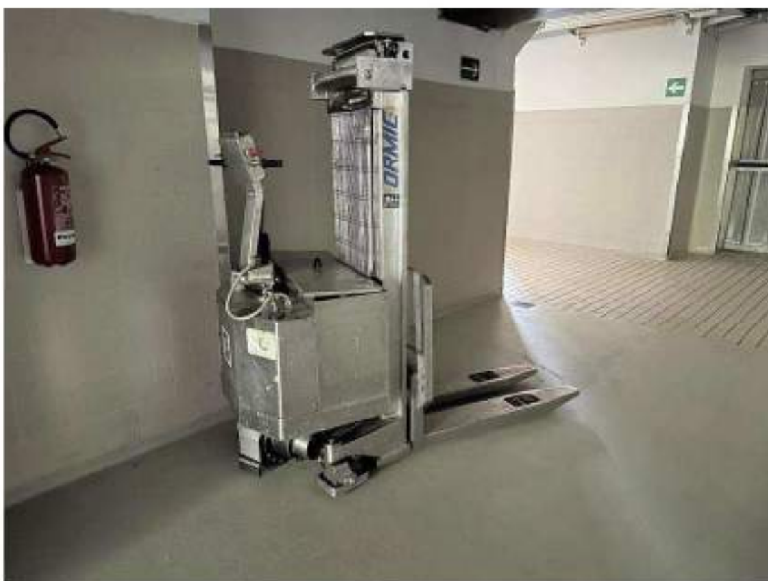
Piano primo. Corridoio tra i locali 18 e 8/A. Particolari finiture. Carrelli acciaio inox su ripiani con ruote. Muletto. Mod. Ormic W20 Kg. 2,000. 0,9 Kw. Anno di messa in servizio: 1998. Cod.01B-013
