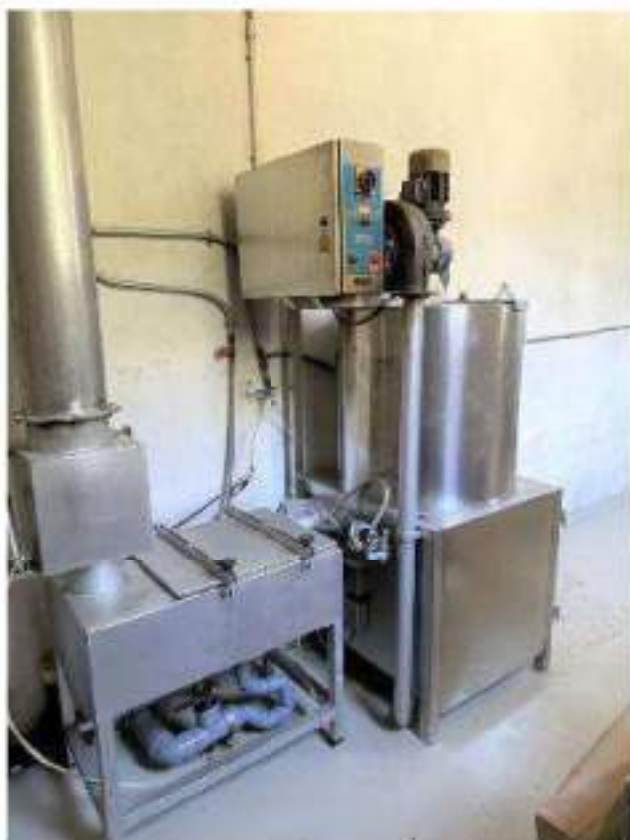
Piano secondo – Locale 41. Forno c/generatore di fumo. Mod. Fessman/Tak Tribus 705. 8 Kw. Anno di messa in servizio: 2007 – cod.02B-001
