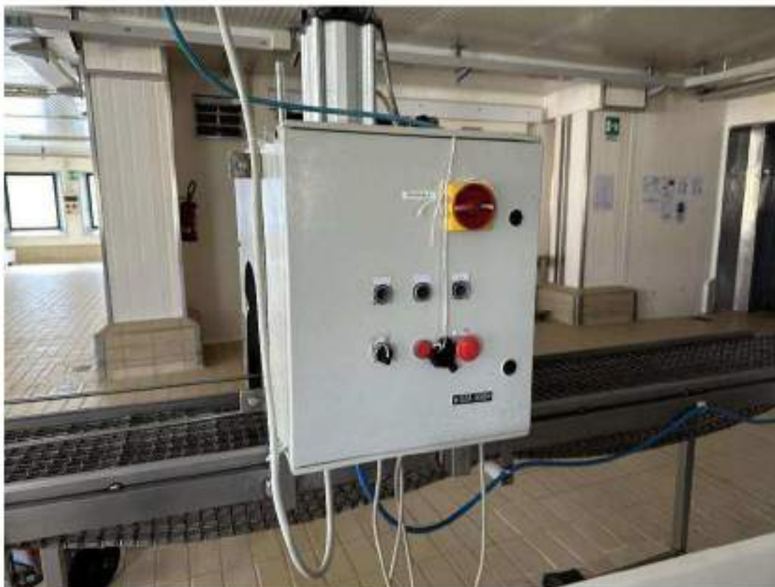
Piano primo. Locale 13:Locale lavorazione prosciutto. Pressastampi automatica. Mod. Pozzi Progeco PR1. 1 Kw. Anno di messa in servizio: 1998. Cod. 02A-000
