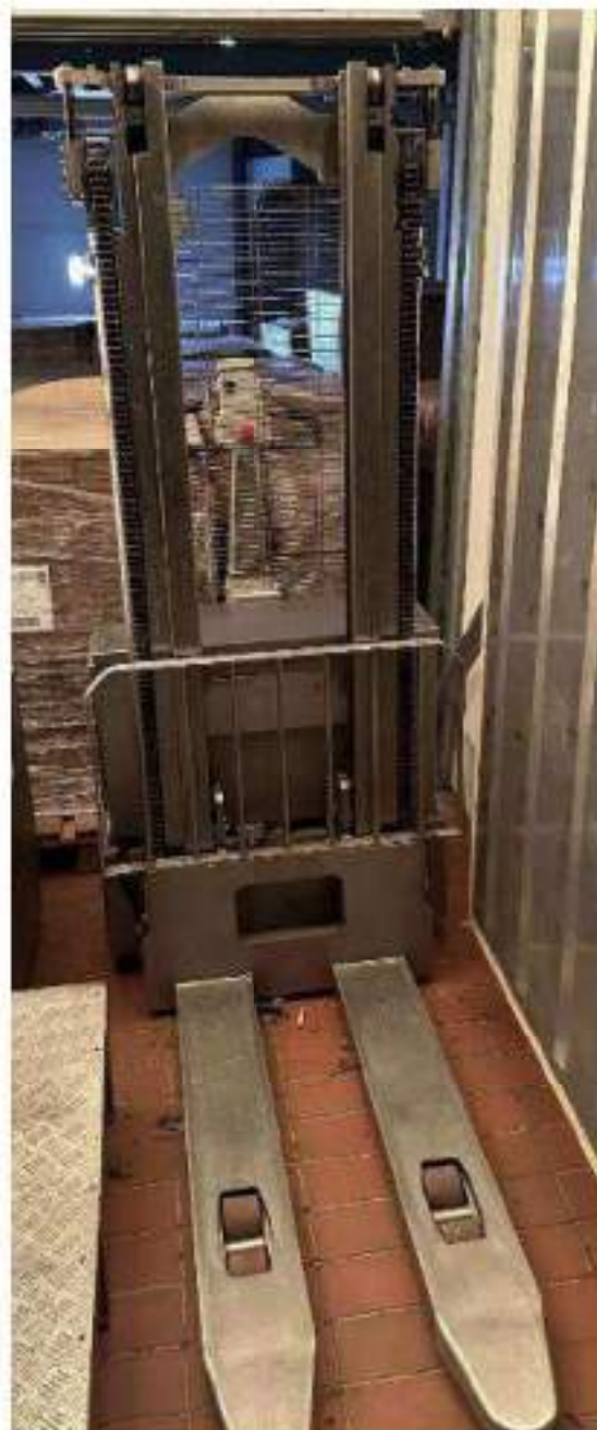
Piano terra. Locale 18A: Scarico carne fresca. Muletto inox. Mod. Samag EL inox Kg 1.300. 1,3 Kw (caricabatterie). Anno di messa in servizio: 2002. Cod. 02-011
