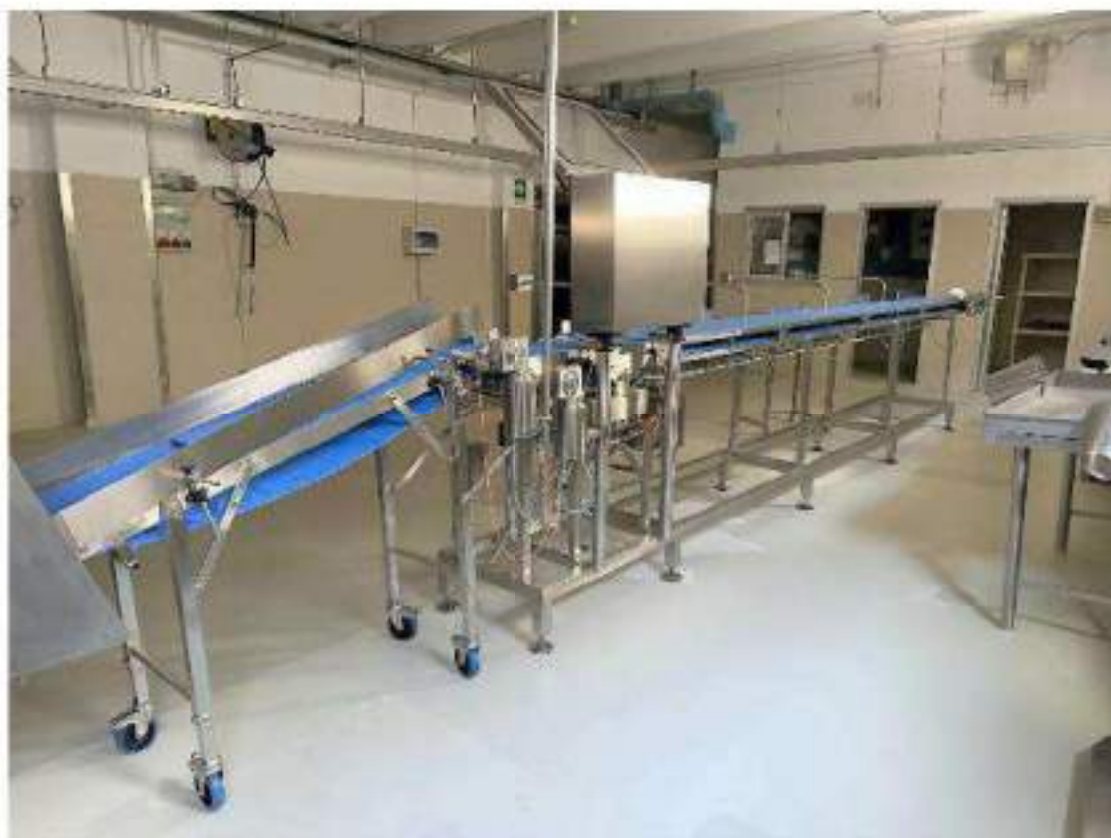
Piano terra. Locale 23: Lavorazione sezionamento. Particolari finiture interne. Selettore di peso a 4 uscite. IB snc, anno messa in servizio 2020, cod. 03-005. Nastri trasportatori e tavoli varie misure in dotazione al macchinario.
