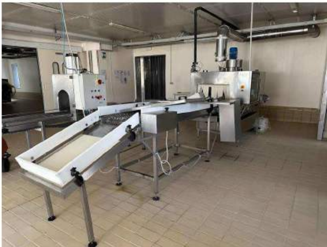
Piano primo. Locale 13:Locale lavorazione prosciutto. Lavastampi. Mod. Colussi Ermes LSC-320. 13 Kw. Anno di messa in servizio: 1998. Cod.02A-003
