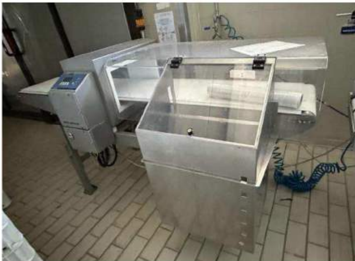
Piano terra. Locale 21: Incartonamento e spedizione. Particolari finiture interne, Metal detector cod. 04-013 con rullo trasportatore
