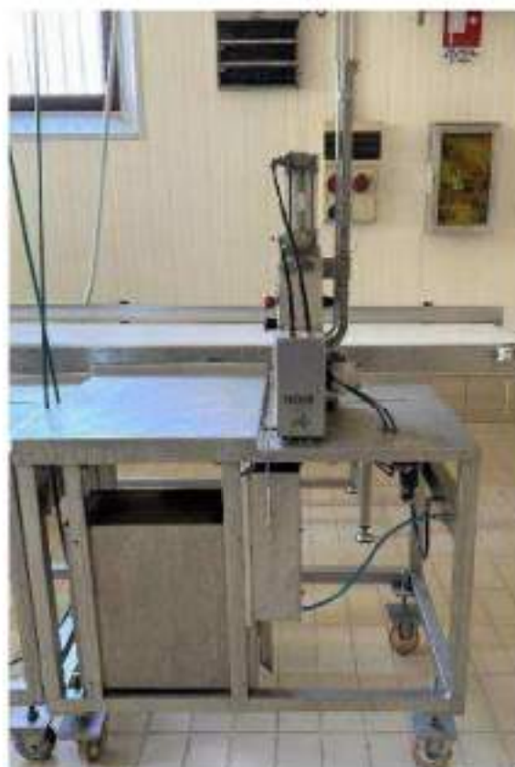
Piano terra. Cella 13: insacco prodotti. Mettirete elastica con nastri trasportatore 01-009, n.2 clippatrici tirabudello. Mod. Tecnobrianza TBA 800. Anno di messa in servizio: 2008 – cod. 01-005, 01-006.
