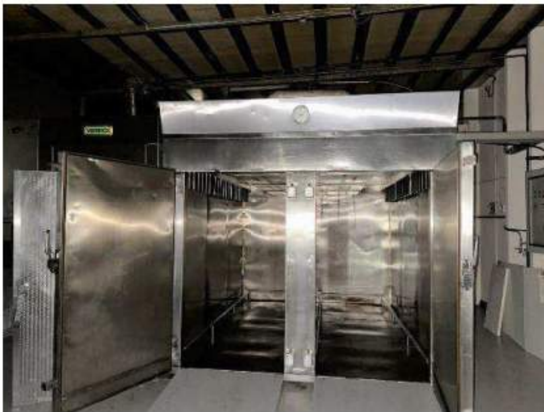
Piano secondo – Locale 10. Forno c/generatore di fumo. Mod. Fessman/Tak Tribus 705. 8 Kw. Anno di messa in servizio: 2007 – cod.02B-001
