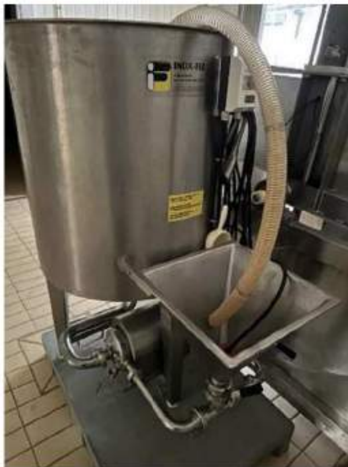
Piano terra, Locale 15-16. Miscelasalina. Mod. Inox-Fer DRE-C4 IF-14/99. 1 Kw Anno di messa in servizio: 1999 – cod.01-024.
