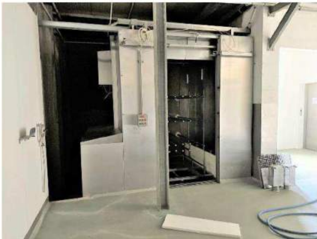
Piano secondo. Locale n.44. Lavaprodotti. Mod. Colussi Ermes 5191. 55 Kw. Anno di messa in servizio: 2004, 03B-000
