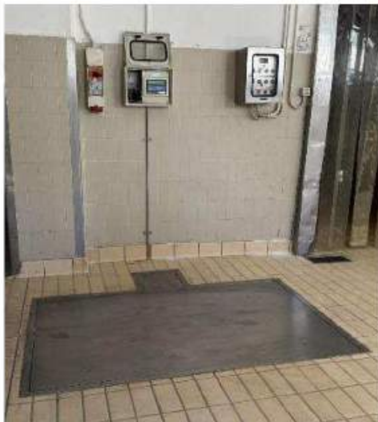
Piano terra. Locale 17: Lavorazione insaccati, cotto e wustel. Pesa a terra. Mod. Bilanciai EV22. 20 w. Attualmente fuori servizio. Anno di messa in servizio: 2002 – cod.01-013
