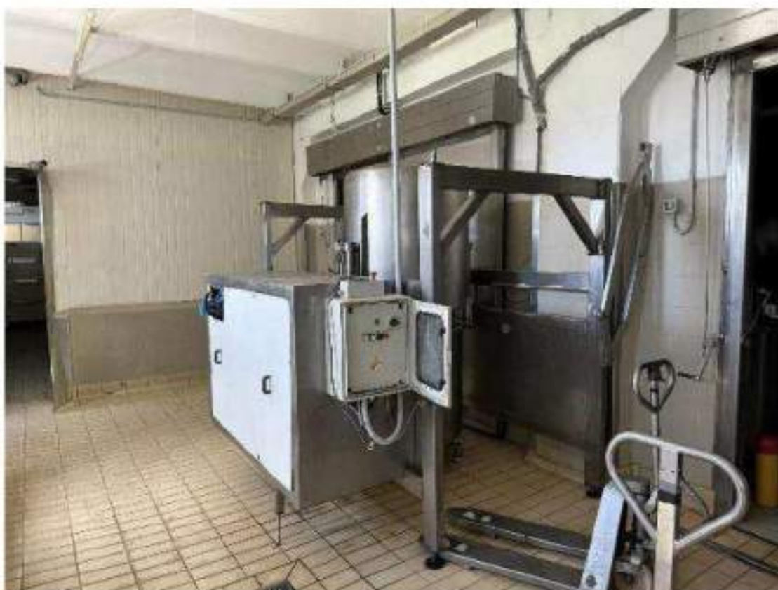
Piano terra. Locale 20: Salatura e zangolatura suino. Zangola bidoni. Mod. Menozzi ZA. 1,1 Kw. Anno di messa in servizio: 1989. ATTUALMENTE FUORI SERVIZIO cod. 02-000
