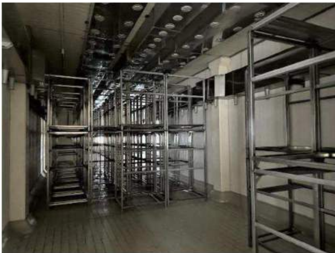
Piano secondo. Cella 6/B: Stagionatura. Mod. Travaglini WS 51. Il motore è in comune con il 5B. Anno di messa in servizio: 1985. Particolari finiture interne. Carrelli acciaio inox portasalumi.
