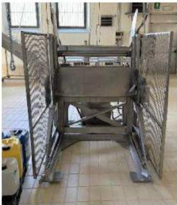
Piano terra. Cella 13: insacco prodotti. Ribaltatore di vasche inox. Mod. Inox Fer 12. 1,6 Kw. Anno di messa in servizio: 2002 – cod.01-002
