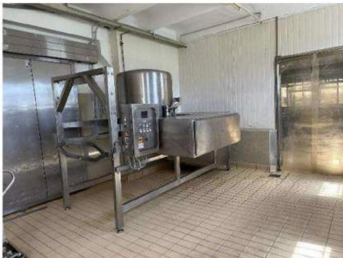
Piano terra. Locale 20: Salatura e zangolatura suino. Zangola sottovuoto. Mod. Menozzi Luigi ZMLS 038. Anno di messa in servizio: 1984 cod. 02-012
