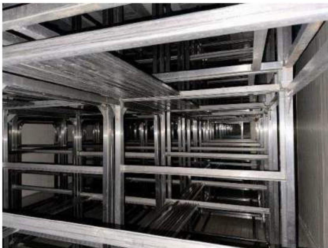
Piano secondo. Cella 1/B: stagionatura. Mod. Travaglini 4888/EL1. 17 Kw. Anno di messa in servizio: 1987. Particolari finiture interne Carrelli acciaio inox portasalumi.
