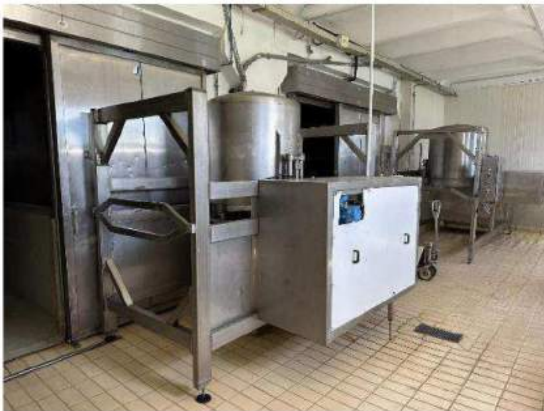
Piano terra. Locale 20: Salatura e zangolatura suino. Zangola bidoni. Mod. Menozzi ZA. 1,1 Kw. Anno di messa in servizio: 1989. ATTUALMENTE FUORI SERVIZIO cod. 02-000
