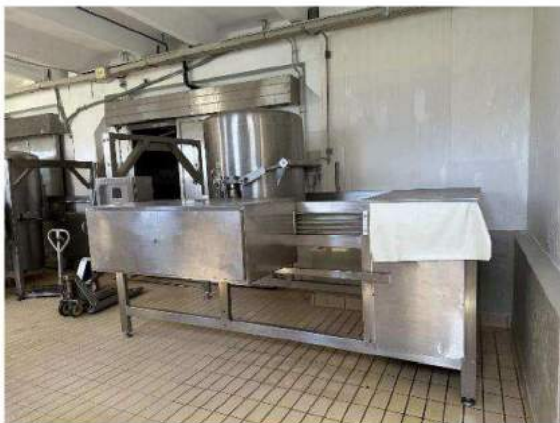
Piano terra. Locale 20: Salatura e zangolatura suino. Zangola sottovuoto. Mod. Menozzi Luigi ZMLS 038. Anno di messa in servizio: 1984 cod. 02-012
