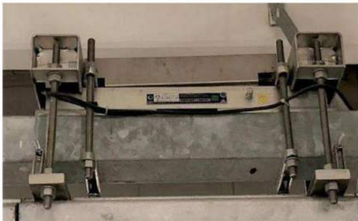
Piano terra. Locale 18: Scarico carne fresca. Lettore Pesa aerea. Mod. Bizerba ST 10245039 600Kg. 20 w. Anno di messa in servizio: 2005 - cod.02-003. Pesa area Bilanciai.
