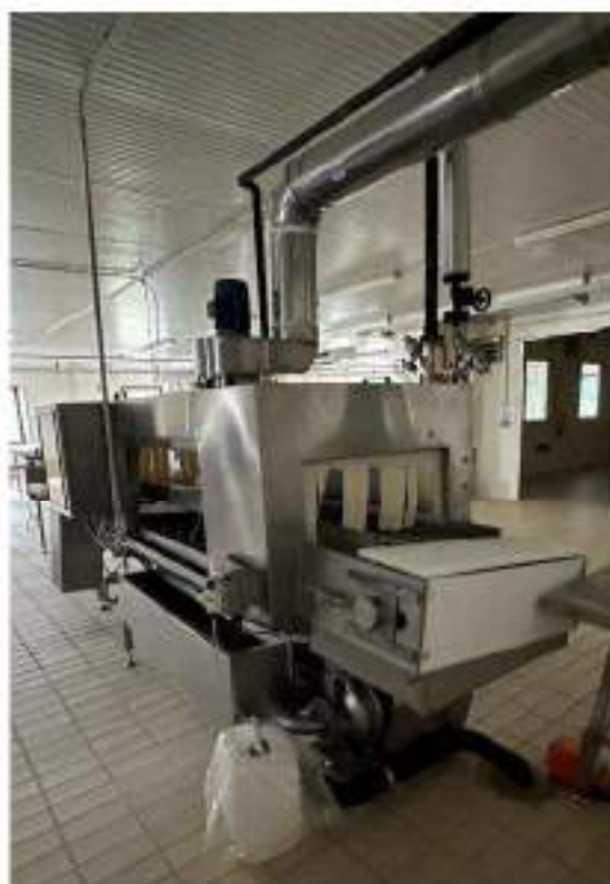
Piano primo. Locale 13:Locale lavorazione prosciutto Lavastampi. Mod. Colussi Ermes LSC-320. 13 Kw. Anno di messa in servizio: 1998. Cod.02A-003
