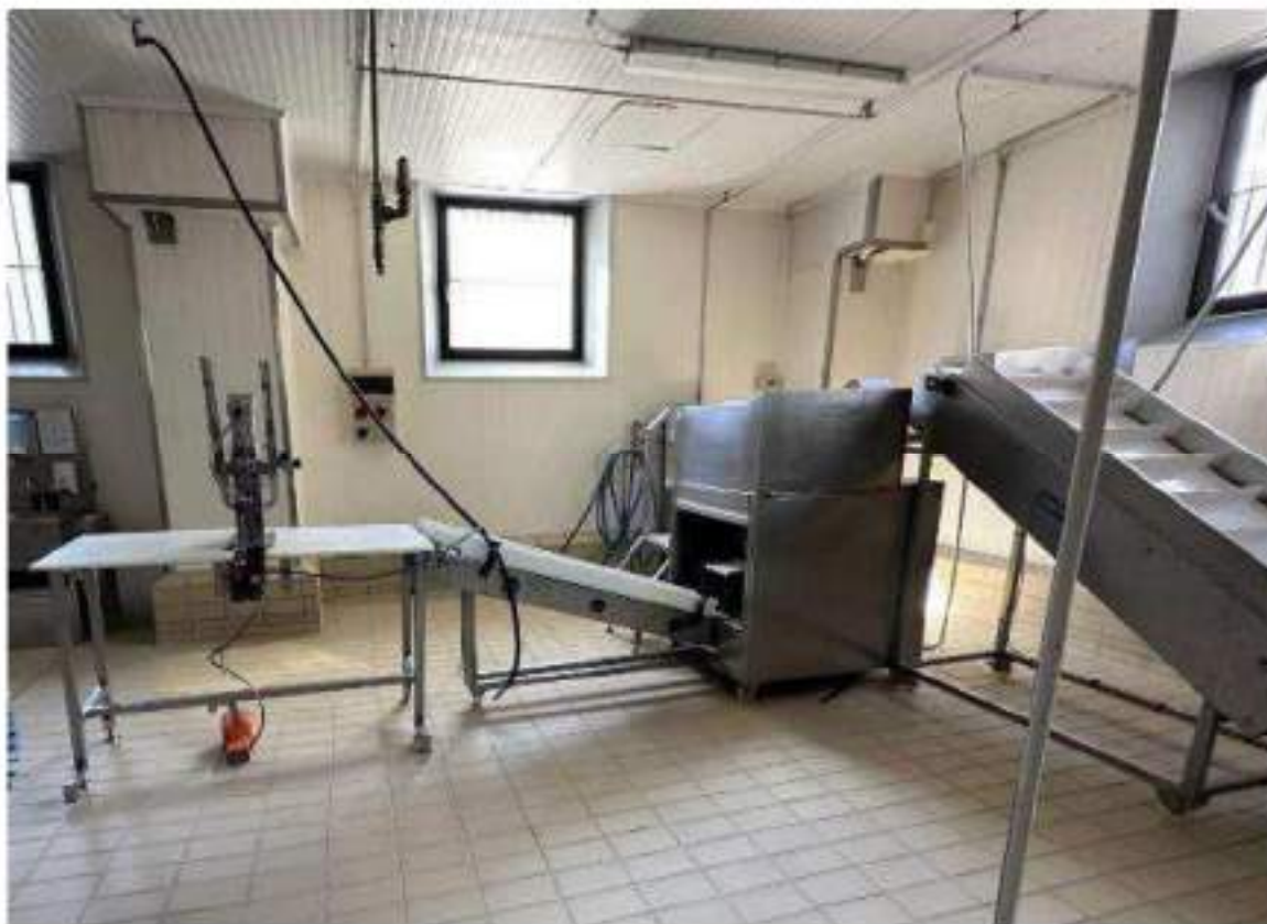
Piano terra. Cella 13: insacco prodotti. Macchina mettere elastica con nastri caricatore ed espulsore. Mod. Tecnobrianza Type SR 200 S. 3,5 Kw. Anno di messa in servizio: 2004 – cod.01-009, con nastri trasportatore
