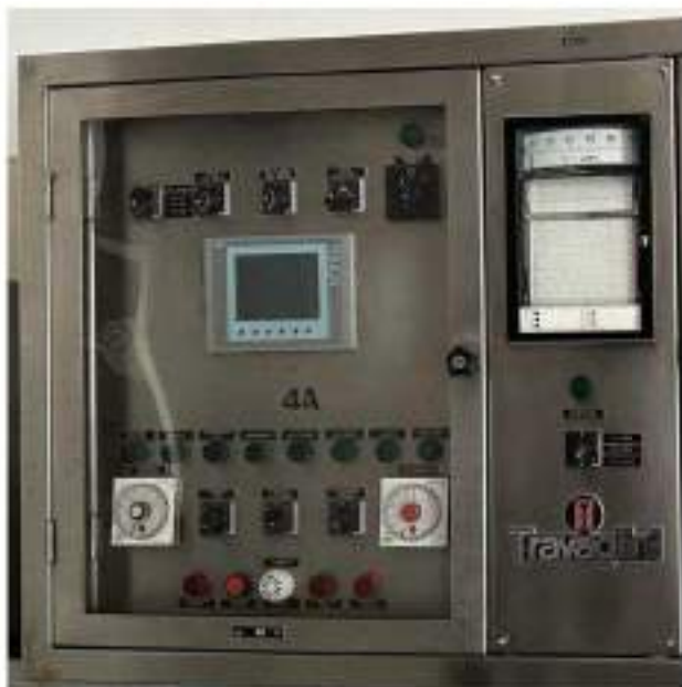
Piano primo. Cella 4/A: asciugamento. Essiccatore. Mod. Travaglini WA 12 P.C. 16 Kw. Anno di messa in servizio: 1985, Particolari finiture interne.
