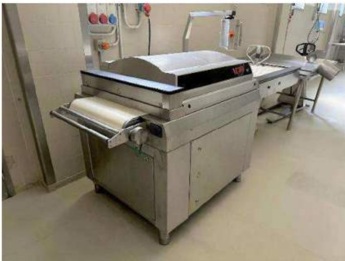
Piano terra, Locale 23: Lavorazione sezionamento. Particolari finiture interne. Termoformatrice a campana. Mod. VC999 K7. 1 Kw. Anno di messa in servizio: 2009. Cod.03-018
