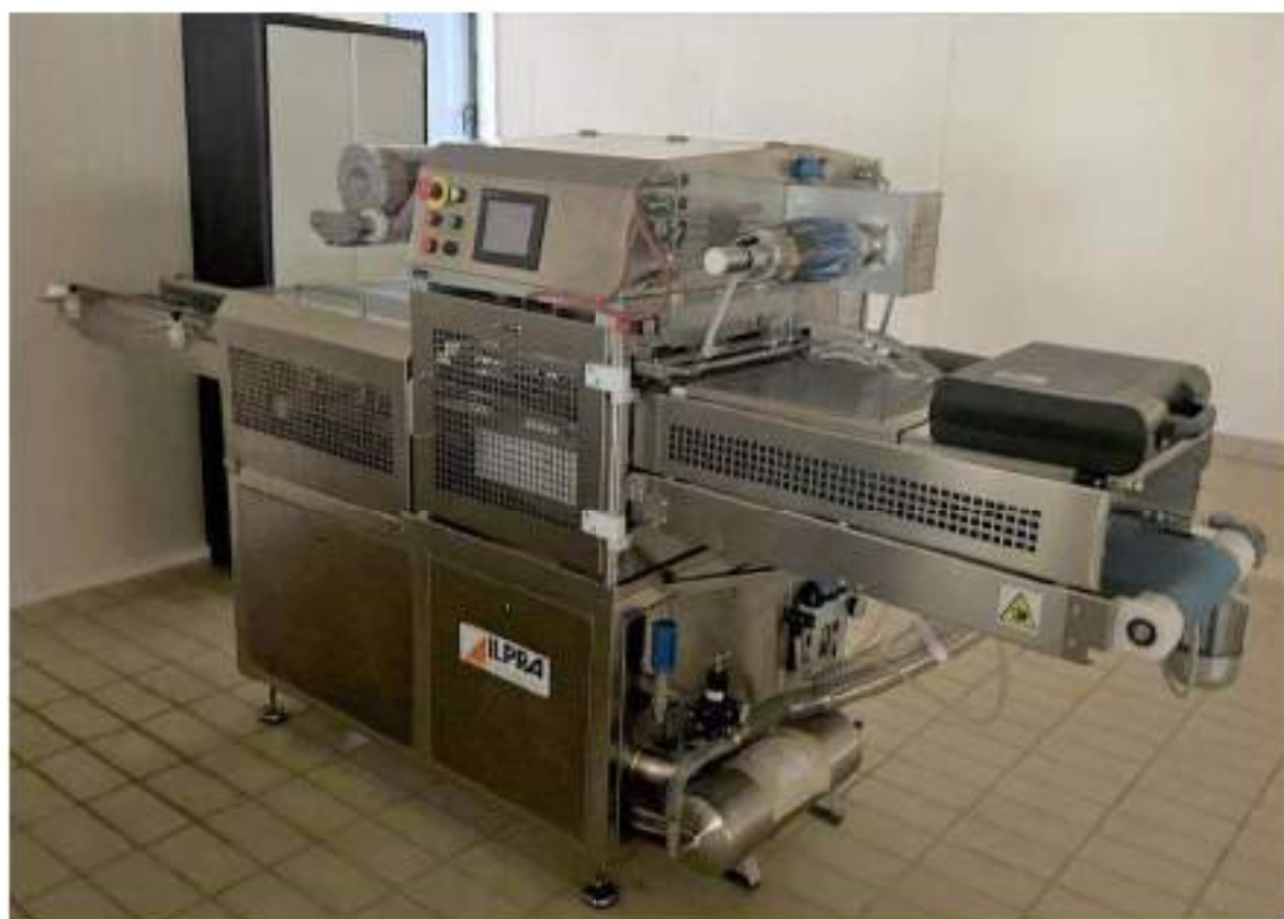
Piano primo. Cella 40. Termoformatrice. Mod. Ilpra FoodPack. 1 Kw. Anno di messa in servizio: 2012. Cod.03A-001
