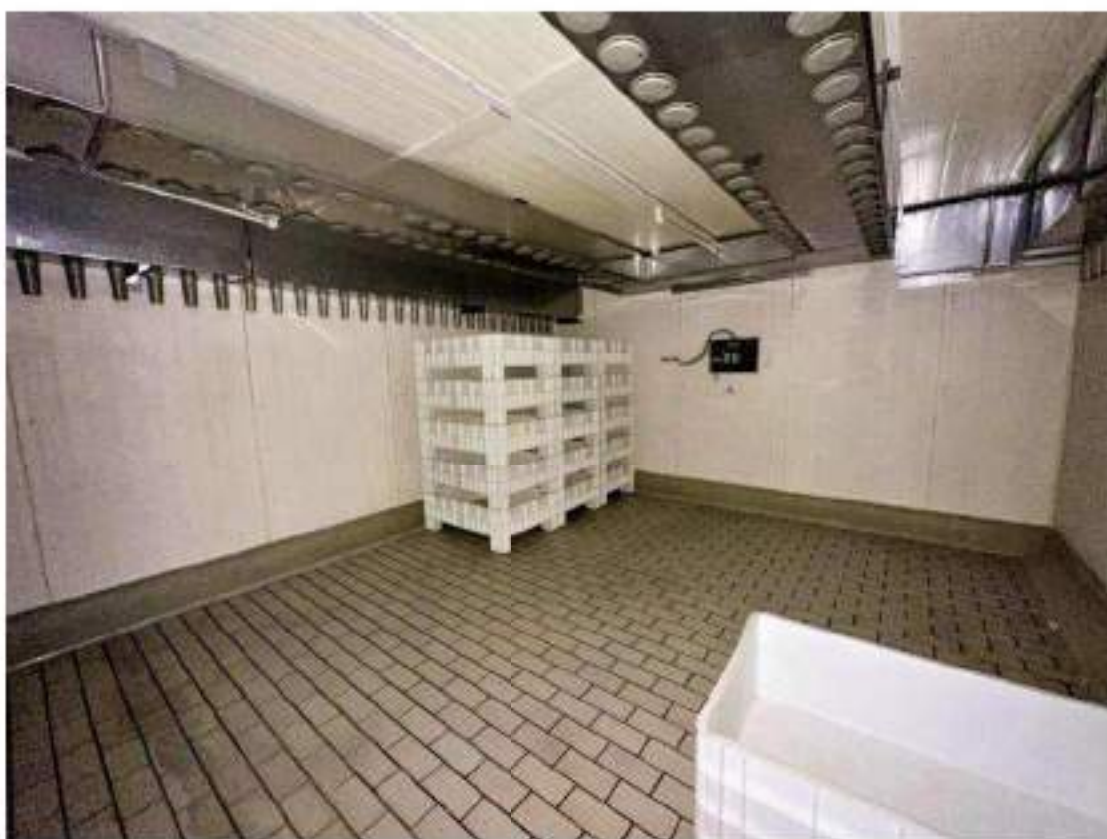
Piano primo. Cella 1/A: asciugamento. Essicatoio. Mod. Travaglini WA 20 P.C. 25 Kw. Anno di messa in servizio: 1985, Particolari finiture interne, n.16 vasche bianche in plastica.
