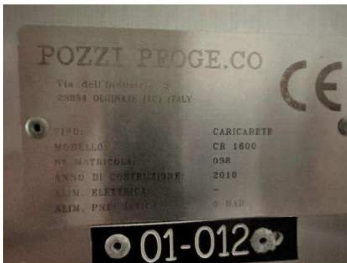
Piano terra. Cella 13: insacco prodotti. Caricarete automatico. Mod. Pozzi Progeco CR-600. Anno di messa in servizio: 2009 – cod.01-012
