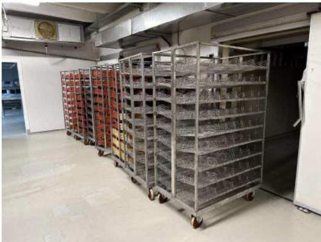
Piano primo. Locale 11/A: Cella raffreddamento prodotto lavorato. Essiccatore. Mod. Aut. 018. 5,5 Kw. Anno di messa in servizio: 2009. Particolari finiture interne. Carrelli acciaio inox a ripiani con ruote con ceste inox/pvc.
