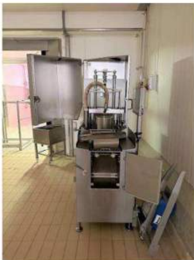
Particolari finiture interne. Piano terra. Locale 15-16. Siringatrice. Mod. Ruhle IR 56. 5 Kw Anno di messa in servizio: 2010 – cod.01-023
