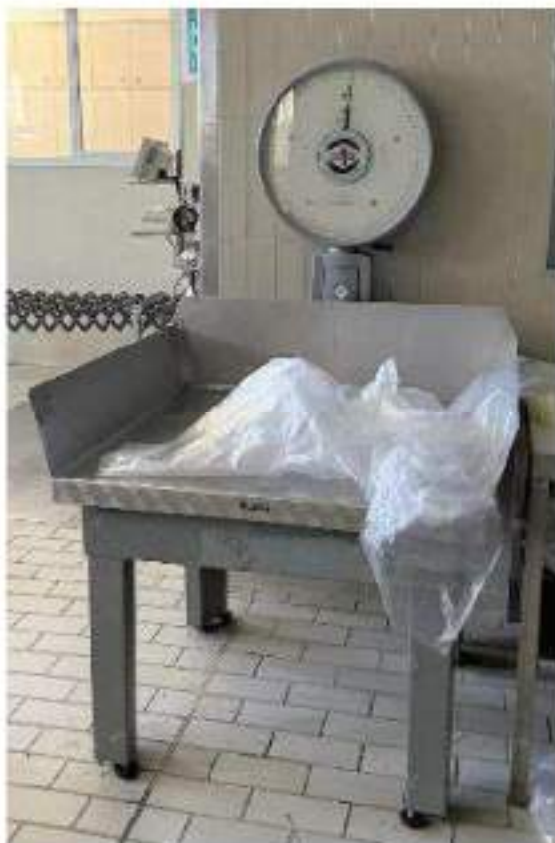
Pesa analogica. Mod. Alfa 25255/B 200Kg. Attualmente fuori servizio. Anno di messa in servizio: 1988 cod.04-004. Tavolo con ripiano.
