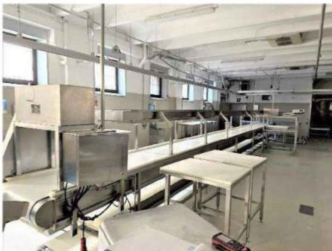
Piano terra. Locale n.23: Lavorazione sezionamento. Particolari finiture interne. Tavolo disosso. Mod. Inox-Meccanica. 5 Kw. Anno di messa in servizio: 1994- cod.03-001
