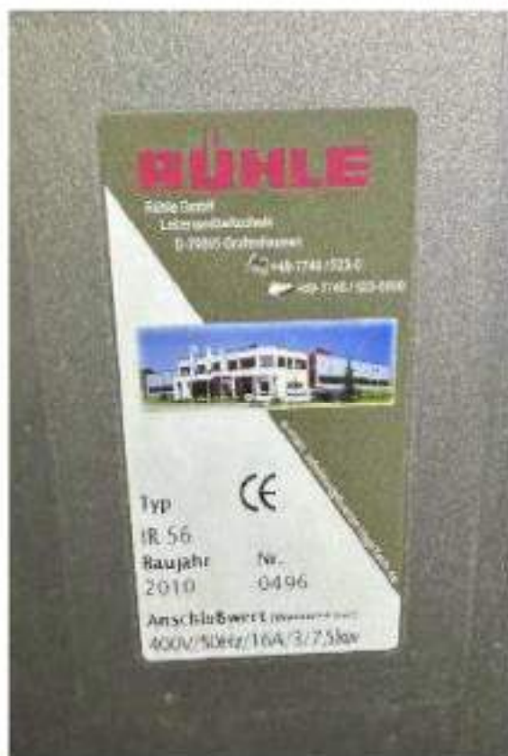
Particolari finiture interne. Piano terra. Locale 15-16. Siringatrice. Mod. Ruhle IR 56. 5 Kw Anno di messa in servizio: 2010 – cod.01-023
