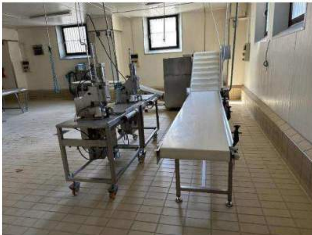
Piano terra. Cella 13: insacco prodotti. Mettirete elastica con nastri trasportatore 01-009, n.2 clippatrici tirabudello. Mod. Tecnobrianza TBA 800. Anno di messa in servizio: 2008 – cod. 01-005, 01-006.
