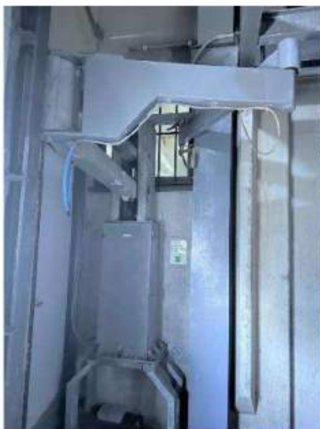
Piano terra. Locale 18A: Scarico came fresca. Braccio meccanico per scarico. Mod. Martinalli. 1,6 Kw. Anno di messa in servizio: 1998
