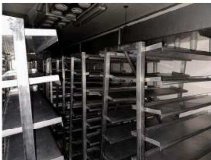
Piano primo. Cella 8/A: asciugamento. Essiccatore. Mod. Travaglini WAS 600.2278. 40 Kw. Anno di messa in servizio: 1993. Carrelli acciaio inox con ripiani. Particolari finiture interne.
