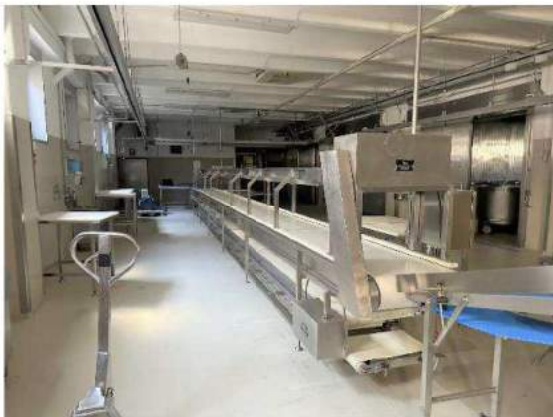
Piano terra. Locale n.23: Lavorazione sezionamento. Particolari finiture interne. Tavolo disosso. Mod. Inox-Meccanica. 5 Kw. Anno di messa in servizio: 1994- cod.03-001
