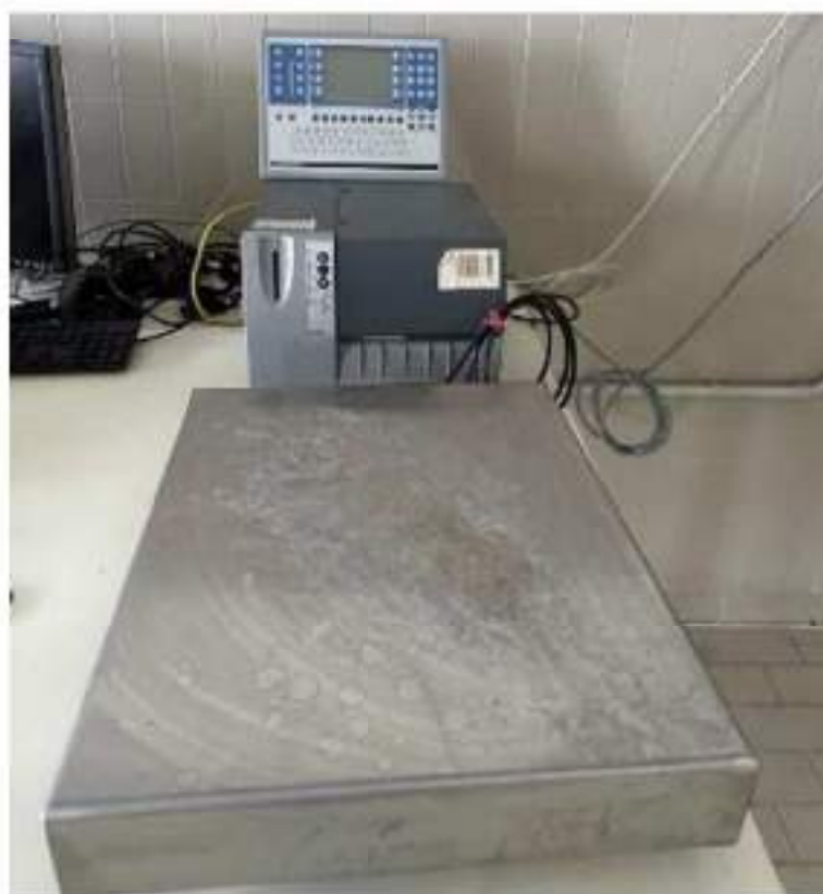
Piano secondo. Locale 15. Appendimento prosciutti. Etichettatrice Bizerba Mod. GLP. 0,1 Kw. Anno di messa in servizio: 2012, 04-014
