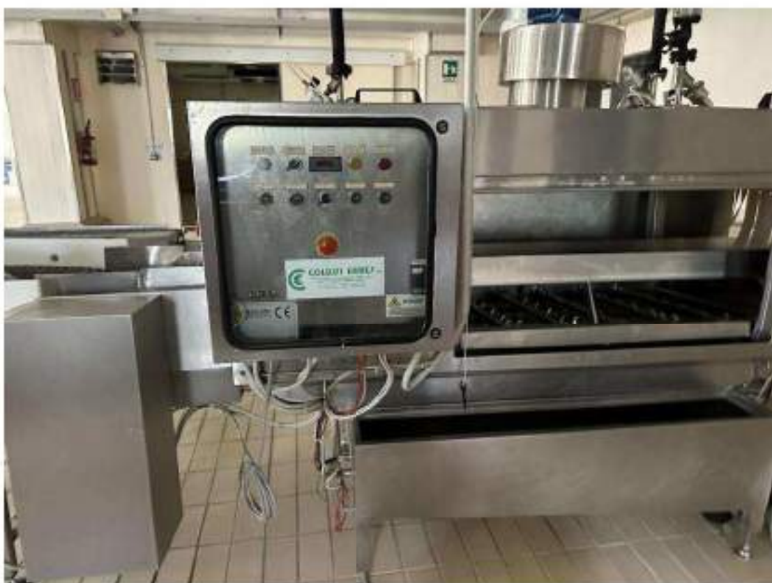
Piano primo. Locale 13:Locale lavorazione prosciutto. Lavastampi. Mod. Colussi Ermes LSC-320. 13 Kw. Anno di messa in servizio: 1998. Cod.02A-003
