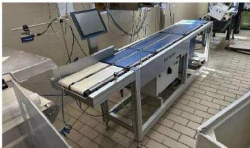
Piano terra. Locale 21: Incartonamento e spedizione. Particolari finiture interne, Metal detector cod.04-013 con rullo trasportatore
