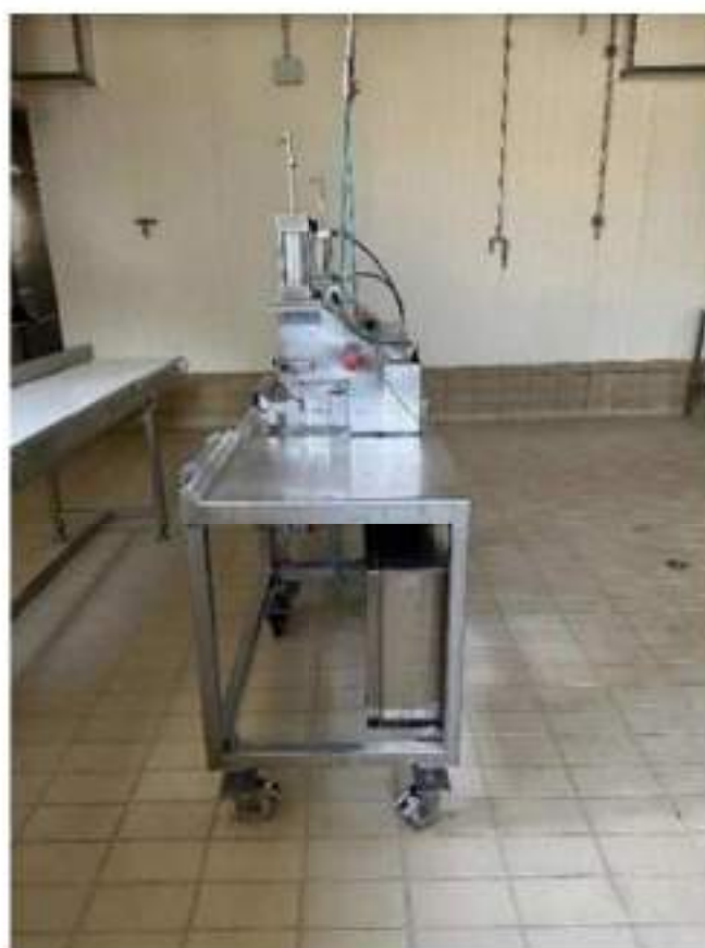
Piano terra. Cella 13: insacco prodotti. Mettirete elastica con nastri trasportatore 01-009, n.2 clippatrici tirabudello. Mod. Tecnobrianza TBA 800. Anno di messa in servizio: 2008 – cod. 01-005, 01-006.
