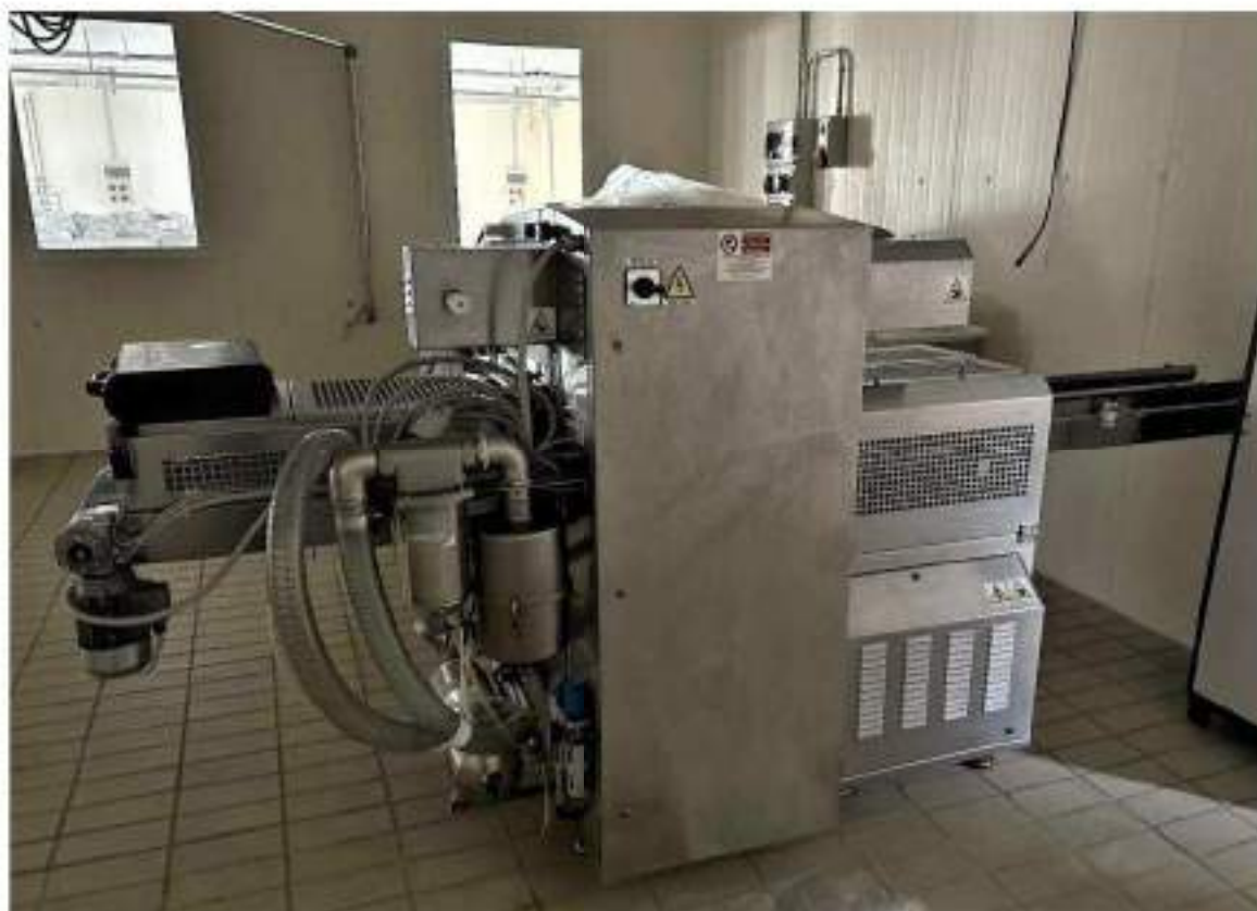
Piano primo. Cella 40. Termoformatrice. Mod. Ilpra FoodPack. 1 Kw. Anno di messa in servizio: 2012. Cod.03A-001
