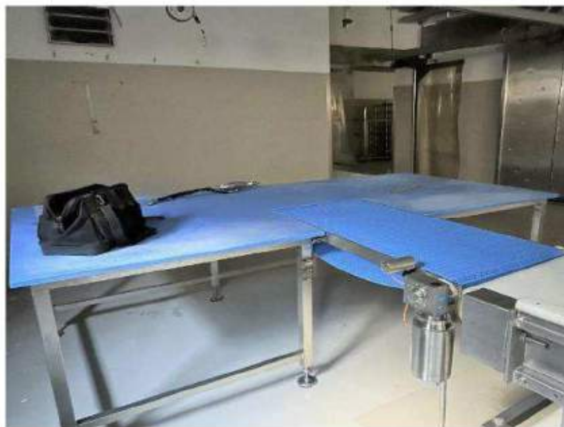
Piano terra. Locale 23: Lavorazione sezionamento. Particolari finiture interne. Selettore di peso a 4 uscite. IB snc, anno messa in servizio 2020, cod. 03-005. Nastri trasportatori e tavoli varie misure in dotazione al macchinario.
