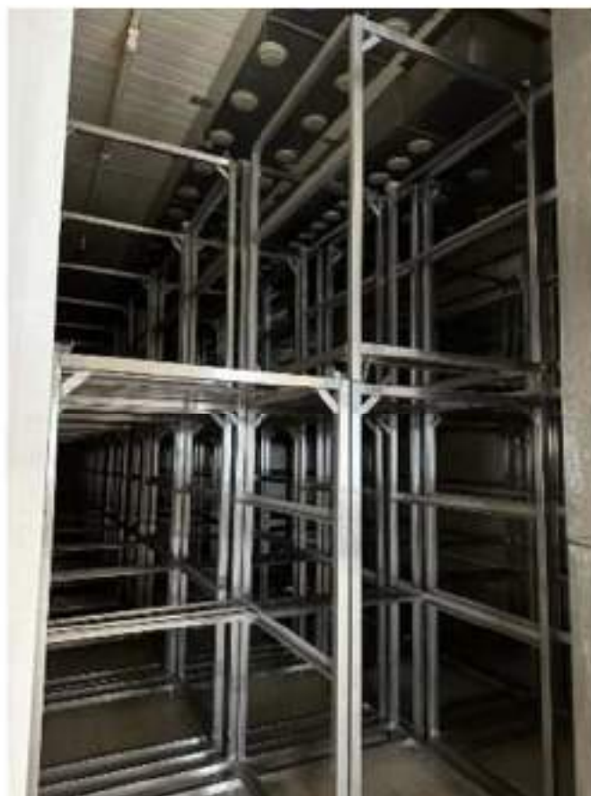
Piano secondo. Cella 4/B: Stagionatura. Mod. Travaglini 2WS/36 PC. Il motore è in comune con il 3B. Anno di messa in servizio: 1985. Particolari finiture interne. Carrelli acciaio inox portasalumi
