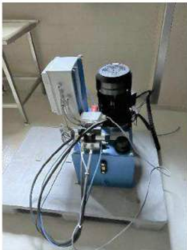
Piano terra. Locale 23. Centralina oleodinamica taglia anchette marca JARVIS, con cesoia JARVIS 525 – 1TB
