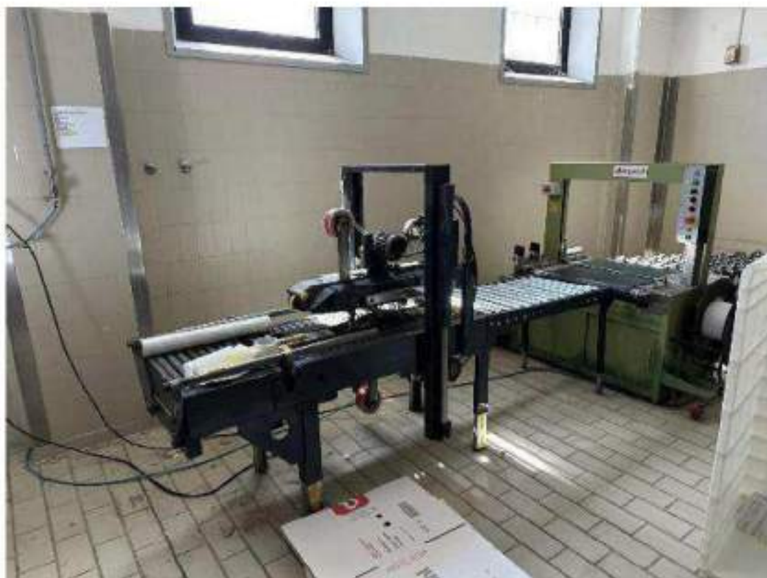
Piano terra. Locale 21: Incartonamento e spedizione. Particolari finiture interne, Nastratrice automatica con rulli di carico e scarico. Mod. Siat SM4. 1 Kw Anno di messa in servizio: 1990 cond.04-001
