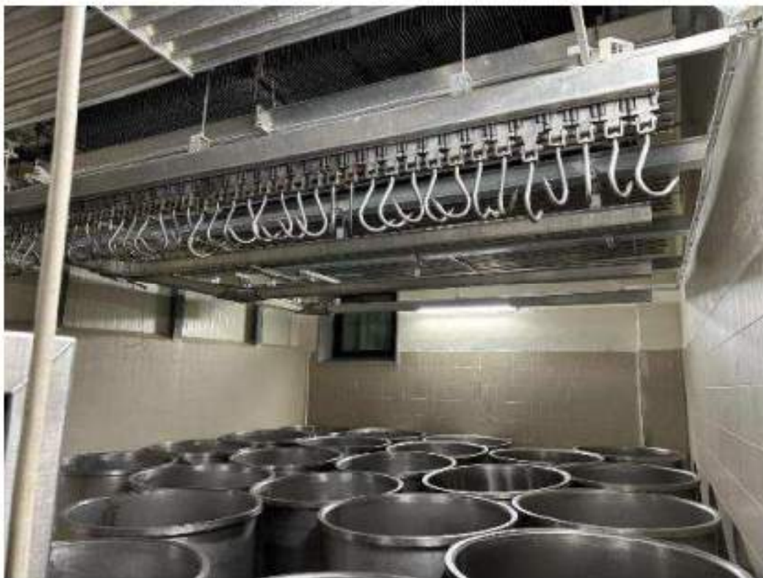
Piano terra. Cella 8: zangolatura prodotti cotti. Particolari finiture interne, contenitori cilindrici in acciaio inox per prosciutti, Zangola sottovuoto. Mod. Tumbler Bauform B6. 0,5 Kw. Anno di messa in servizio: 2004 – cod.01-020, binario con ganci.
