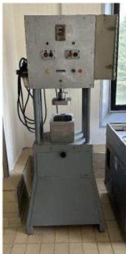
Piano primo. Locale 13:Locale lavorazione prosciutto. Pressa prosciutti. Mod. Aut 215. 1,8 Kw. Cod. 02A-013 - NON A NORMA
