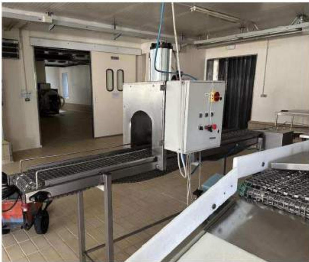
Piano primo. Locale 13:Locale lavorazione prosciutto. Pressastampi automatica. Mod. Pozzi Progeco PR1. 1 Kw. Anno di messa in servizio: 1998. Cod. 02A-000
