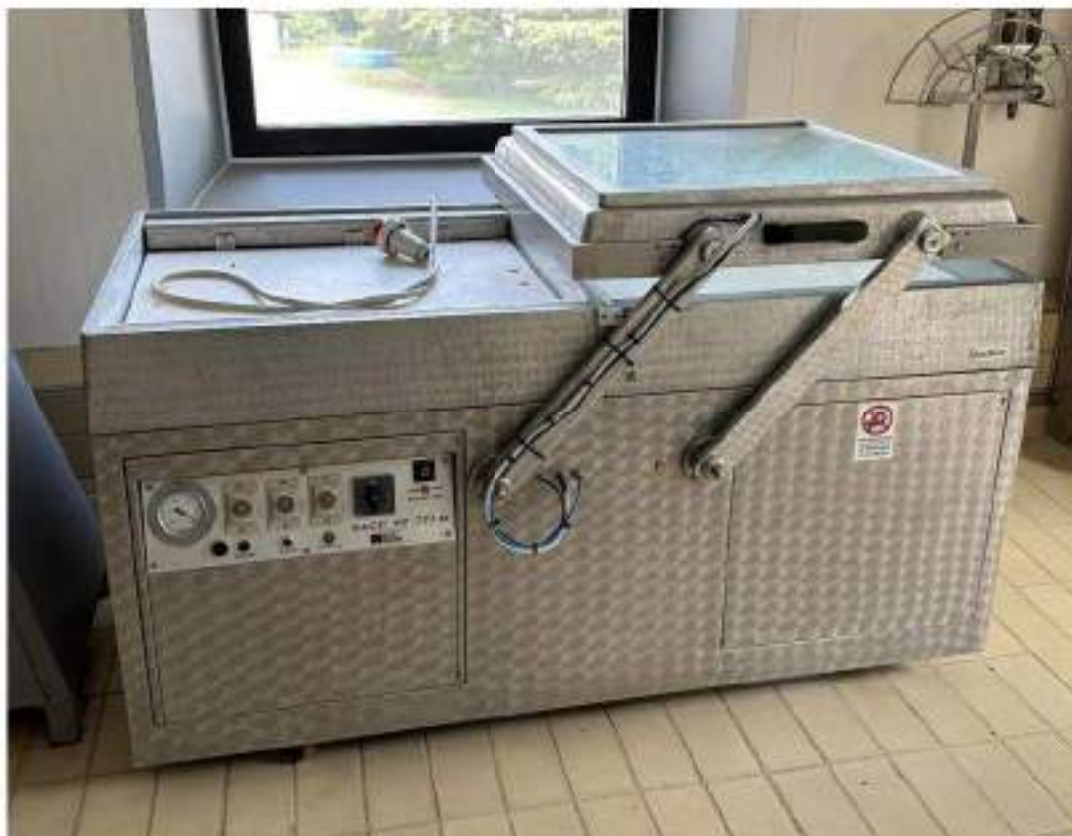
Termoformatrice a campana. Mod. Saccardo Sacc VC 770. 3 Kw. Anno di messa in servizio: 1988. Cod. 02A - 015
