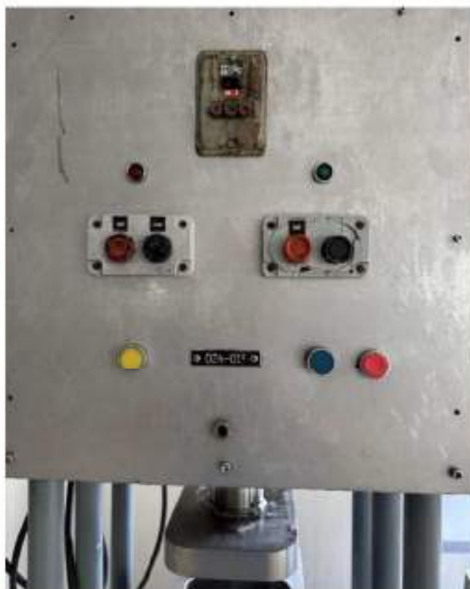
Piano primo. Locale 13:Locale lavorazione prosciutto. Pressa prosciutti. Mod. Aut 215. 1,8 Kw. Cod. 02A-013 - NON A NORMA
