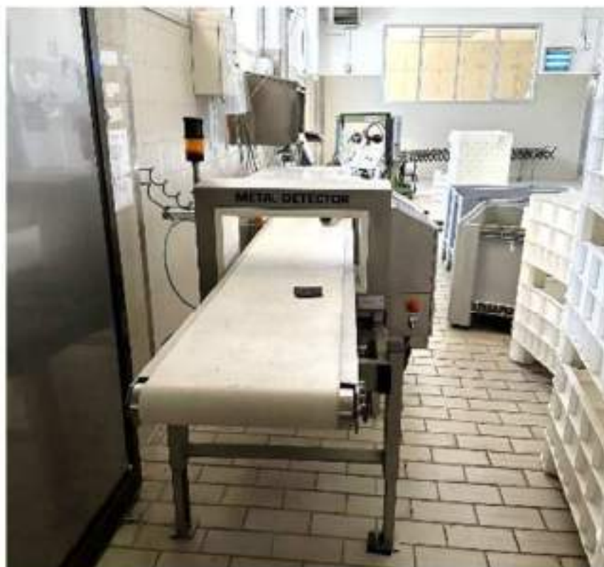
Piano terra. Locale 21: Incartonamento e spedizione. Particolari finiture interne, Metal detector cod. 04-013 con rullo trasportatore
