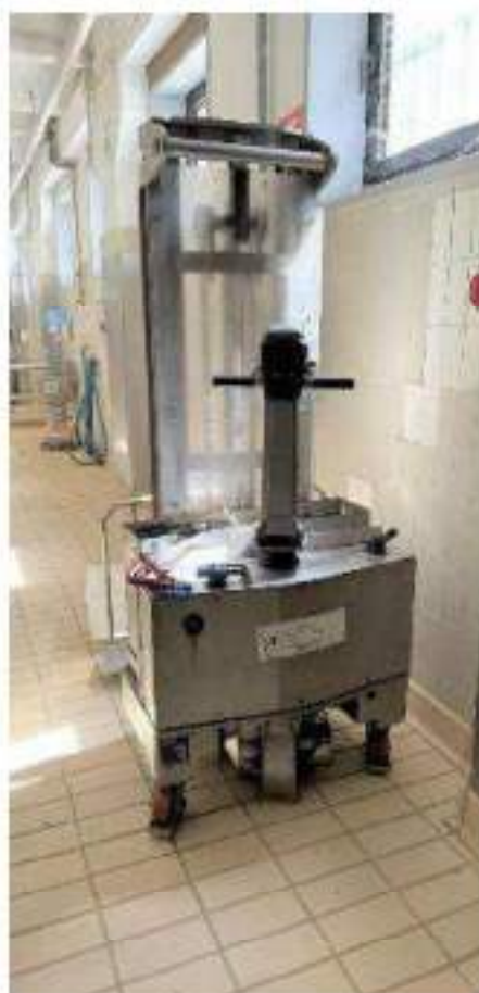
Piano terra, Locale 17: Lavorazione insaccati, cotto e wustel. Muletto inox. Mod. Samag EL 10 INOX Kg 1.000. 1,3 Kw (caricabatterie) Anno di messa in servizio: 1990 – cod.01-037.
