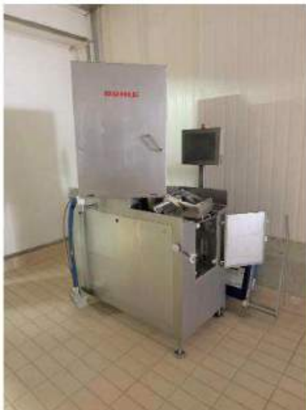
Particolari finiture interne. Piano terra. Locale 15-16. Siringatrice. Mod. Ruhle IR 56. 5 Kw Anno di messa in servizio: 2010 – cod.01-023
