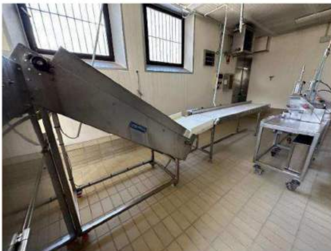
Piano terra. Cella 13: insacco prodotti. Macchina mettere elastica con nastri caricatore ed espulsore. Mod. Tecnobrianza Type SR 200 S. 3,5 Kw. Anno di messa in servizio: 2004 – cod.01-009, con nastri trasportatore
